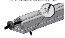
Подключить сетевой провод к клеммной колодке в соответствии с указанной полярностью:
